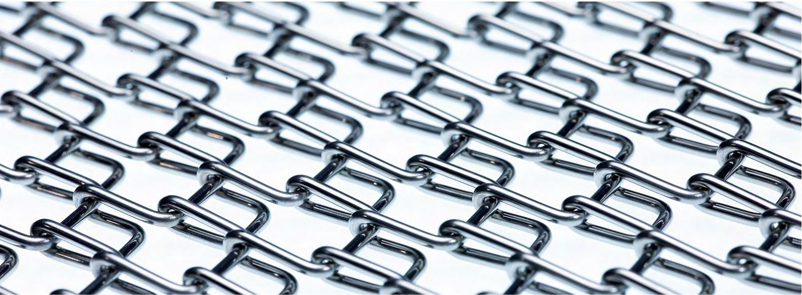
Compact-Grid™ 不锈钢输送网带是为体积较小而需要全面支撑的输送产品专门设计。独特的网格结构具有70%的开孔面积，使清洗更加容易，为加热、冷却和涂层工艺提供最大限度的空气及液体流通。Compact-Grid™ 输送网带使用齿轮驱动，网带在轨道上不走偏，即使在承载较重的情况下也能保证网带平稳直行。拼接网带简单省时，使网带安装的工作更加轻松。
